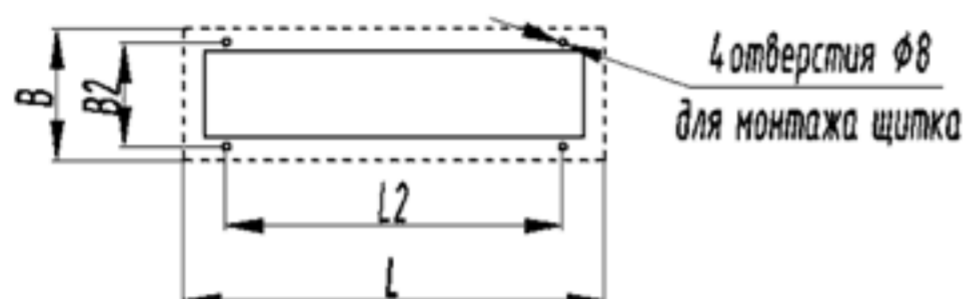
Рис. 6.2.3. Схема разметки отверстий для монтажа корпуса ЩР(в) (напольного).
